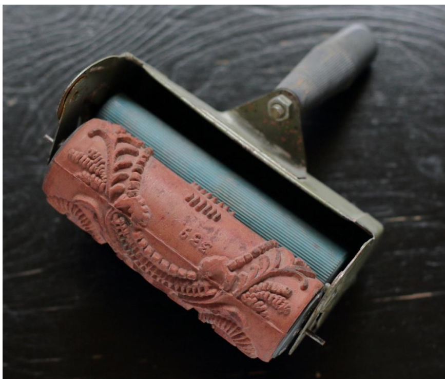
Il. 11. Uchwyt malarski ze zbiornikiem i wałkami nadającymi farbę.
