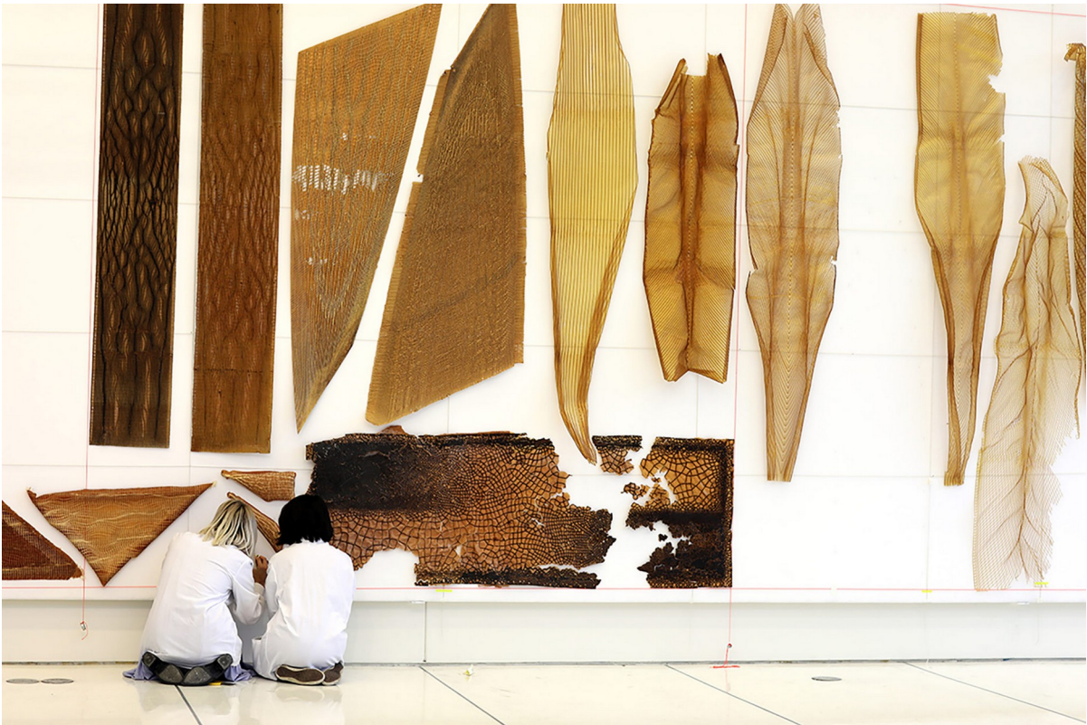
il. 143. Neri Oxman, części konstrukcyjne słupów biostrukturalnych, druk 3D, MIT Cambridge 2015
